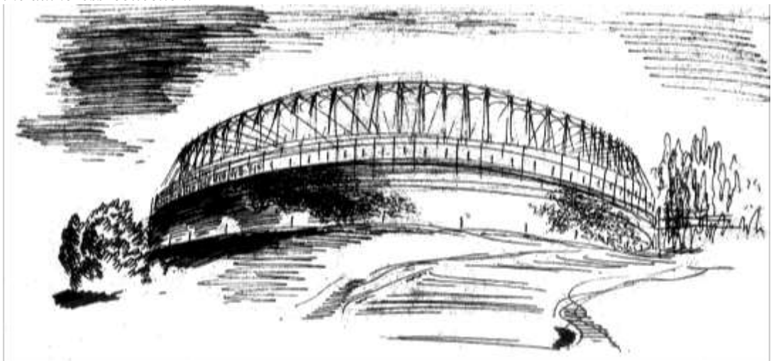
II.3. Praca architektoniczna -śródmieście Warszawy ; tu: szkic budynku Parlamentu z dachem wiszącym – konstrukcja typu koła rowerowego, antycypująca Arenę w Raleigh; M. Nowicki ; źródło: fotografie F. Zwierzchowskiego, z kolekcji autorki
