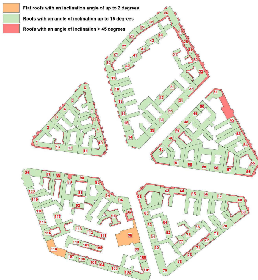
Drawing 2. Analysis of roofs in terms of the type and angle of inclination of roof slopes in individual blocks. Source: original work. II. 5. Analiza dachów pod względem rodzaju i kąta nachylenia połaci dachowych w poszczególnych kwartałach. Źródło: opracowanie własne.
